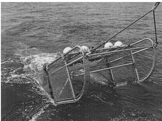
写真1 異体類採集用ソリネット (桁幅2m)
