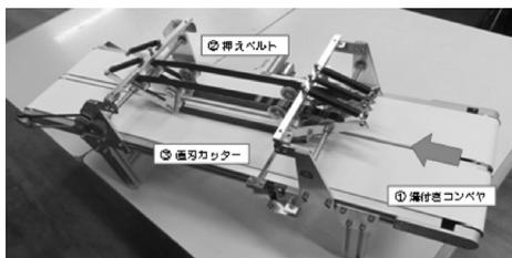
図5 開発した皮・血合肉同時除去装置
