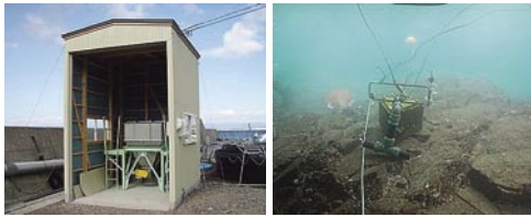
図3 栄養塩添加装置(左)と栄養塩放出口(右)
