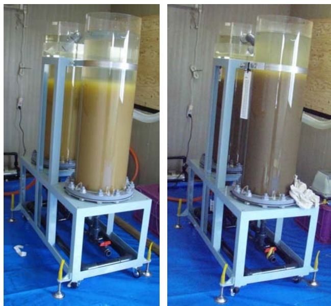
図3 網走湖に導入されたピン式孵化器 左：収容直後 右：孵化近く
