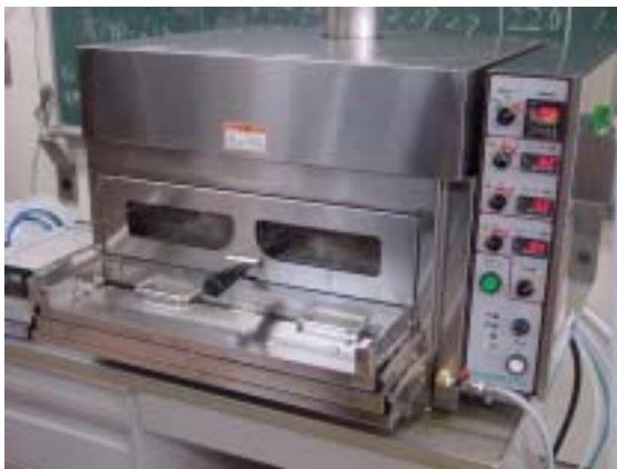
写真1 過熱水蒸気発生装置
