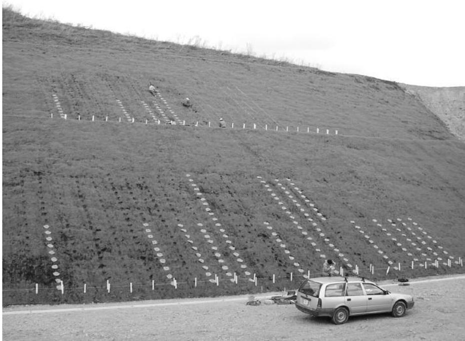
写真-1 植栽試験地遠景 (2002年4月18日)。丸く見えるのがマルチング。
