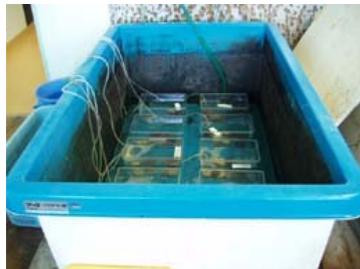
写真 4 アンモニアに対する耐性を調べる
