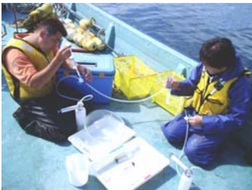
写真 3 自作した採水器で湖底直上の海水を吸い上げる
