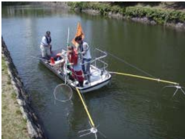
図 3 電気ショッカーボート (感電したブルーギルをタモ網ですくう)
