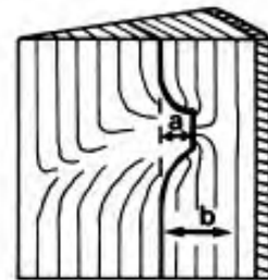
図-3 枝打ち木の断面図 a: 残枝長, b: 巻き込み長
