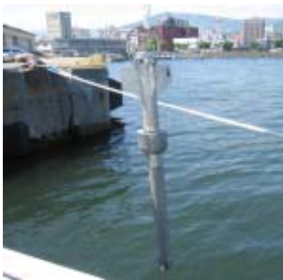
図3 堆積物を柱状に採取する採泥器
