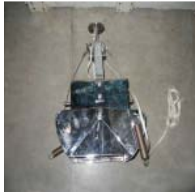
図2 表層の堆積物を採取する採泥器
