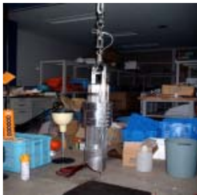
図3 堆積物を柱状に採取する採泥器
