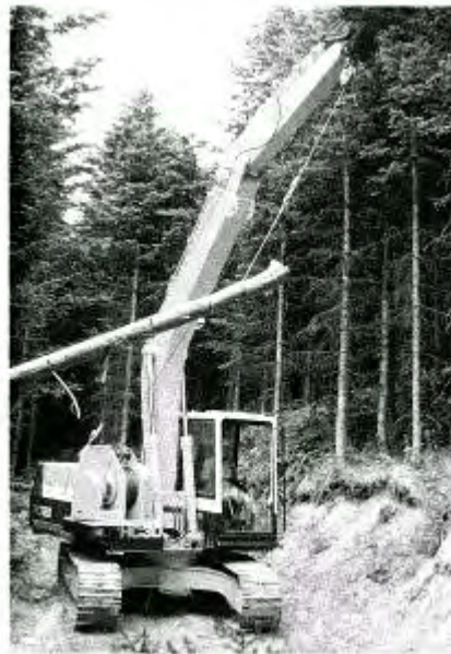
写真 - 1 ウィンチ付きパワーショベル
