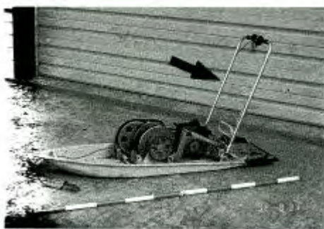
写真 - 1 使用した簡易ウィンチ （矢印は操作ハンドル）
