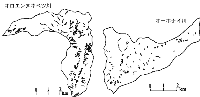
図-4 航空写真から判読した2流域の急斜面の分布 図中黒塗りの部分が平均斜度25度以上の急斜面をあらわす。
