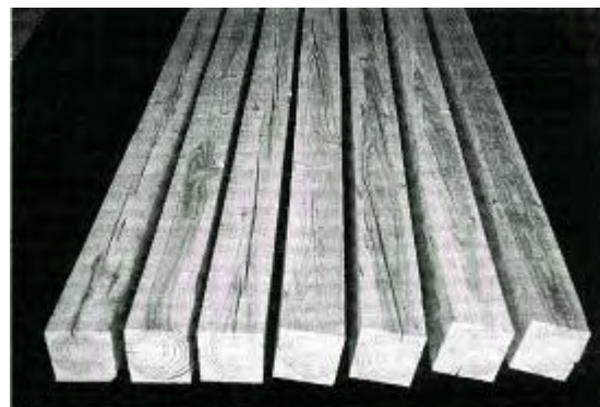
写真 - 1 乾燥にともなうカラマツ材のねじれ
