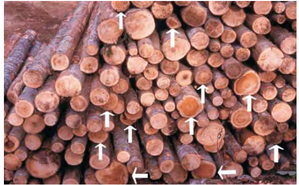
写真 - 2 土場に積まれたパルプ材 (オレンジ色の腐朽木が多い)
