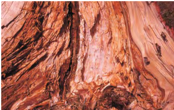
写真 - 5 腐朽材の様子 (繊維状の腐朽材の間に白色～クリーム色の菌糸が蔓延している)
