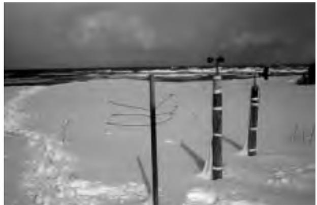
写真-1 石狩浜に設置した糸トラップ(写真中央) 右は風速、風向計
