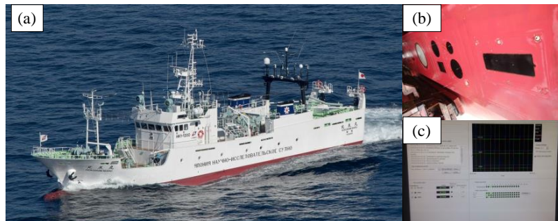
図2 (a) 釧路水産試験場所属「北辰丸（2014年に新造）」(b) 同船底面写真（黒杵や白杵が魚探やADCPなどの音響機器）(c) 音響同期制御装置
