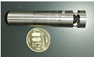
図 1 調査で使用したデータロガー 長さ 74 mm で(有)リトルレオナルド社製のものを使用した
