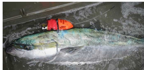
図 2 データロガーを装着したブリ 赤い浮きにデータロガーを挿入して装着した
