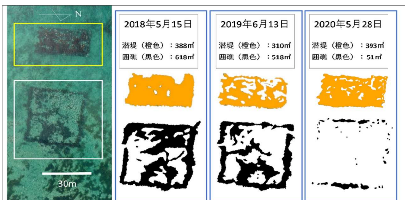
図3 寿都町美谷地区の潜堤と囲い礁 黄色囲いが潜堤（藻場面積は橙色）、白囲いが囲い礁（黒色）の藻場面積算定エリアを示す。
