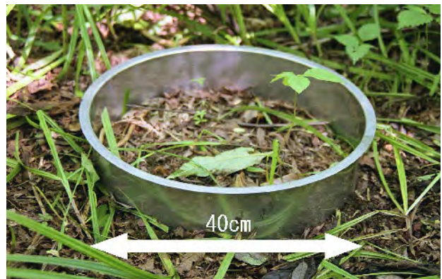
写真-1 土壌のメタン吸収量を測定するための円筒形のチャンバー
