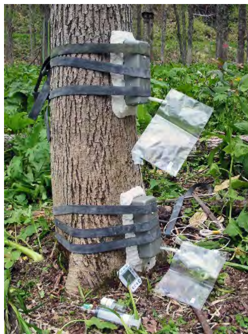
写真-2 ヤチダモの幹からのメタン放出量の測定
