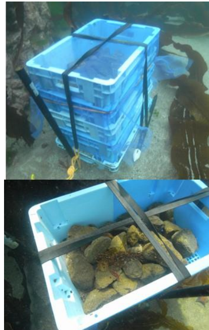
写真 18 こぶし大の石を積めて 5 段に積み重ねたトレイ 底面は 11 mm目の格子になって上下移動はできるが側面からは移動できない
