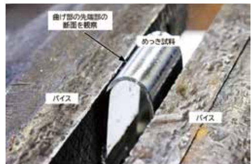
曲げ加工を行っても剥離が生じない亜鉛めっき
