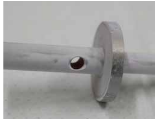
浸透探傷法による亀裂の確認
