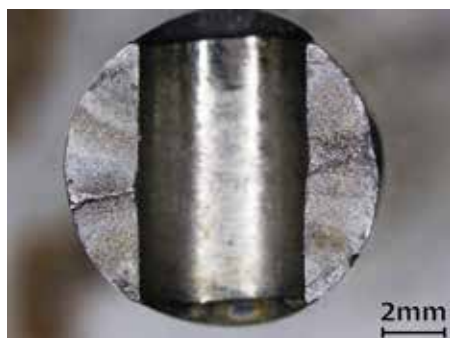
破面 (両振り曲げによる疲労破壊 の特徴を有している)
