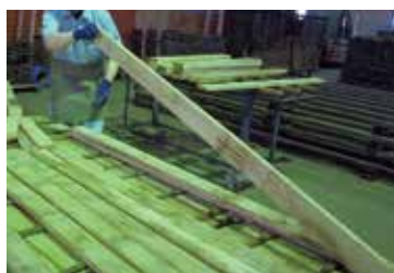
図1：原板の歪み検査の様子
