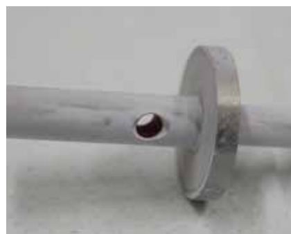
浸透探傷試験による亀裂の確認 (もしも亀裂があれば先に塗布し た赤い塗料が染み出す。)
