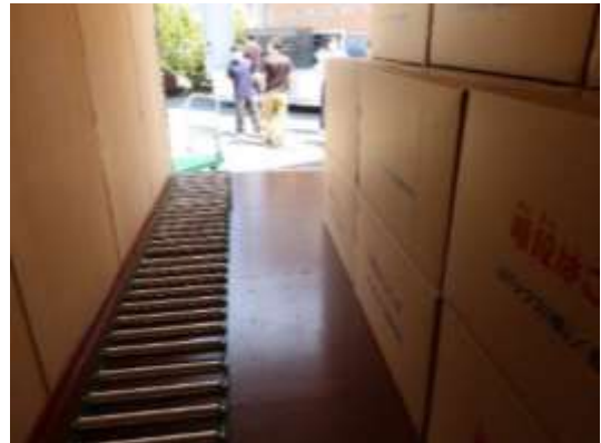
(c) ローラーコンベア設置状況
