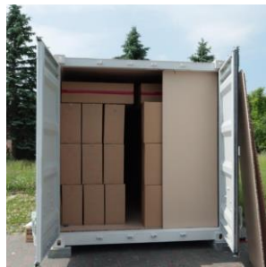
(b)保管状況(通気資材張り)
