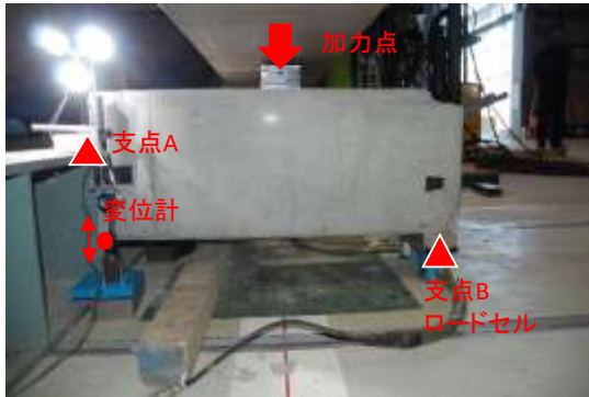
写真 5-1 試験体加力状況
