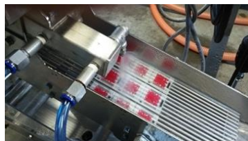
開発した洗卵システム全景 人造イクラを用いた着色剤洗浄試験
