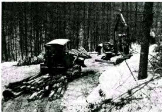
写真 - 2 トラクタによる短幹けん引き集材作業とグラップルローダによる選別巻立作業
