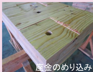
座金のめり込み試験
