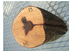
写真-1 幅の狭い溝と内部腐朽の関係
