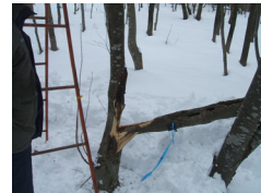
写真-2 引き倒し試験で折れたナナカマド二股部位
