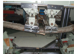
写真-3 曲げ強度試験の実施状況
