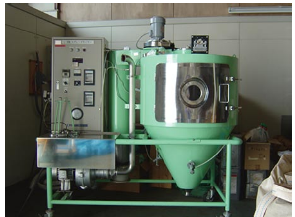
写真 2 スプレードライヤー
