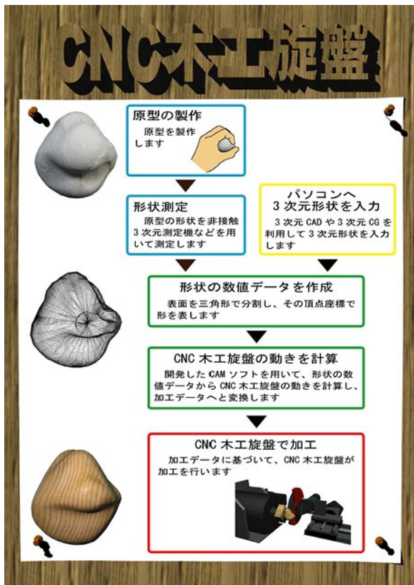
CNC木工旋盤のパネル
