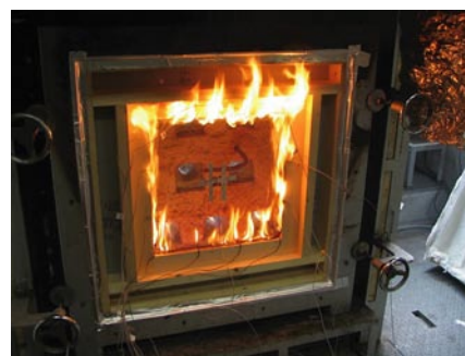
写真2 小型壁炉による木製サッシの遮炎性能試験
