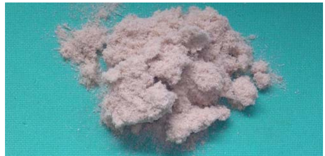
写真3 解繊試験で得られた木材ファイバー
