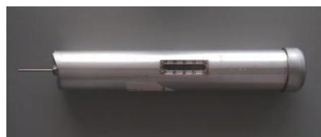
写真2 ピン打ち込み機器「ピロディン」 ※腐朽が進んだ部材ほどピンが深く打ち込まれる
