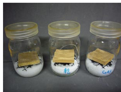
写真4 培養瓶を用いた試験片の変色試験
