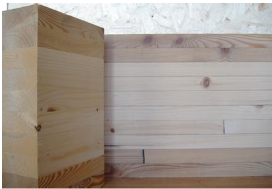
ダフリカカラマツ (外層) と トドマツ (内層) による構造用集成材
