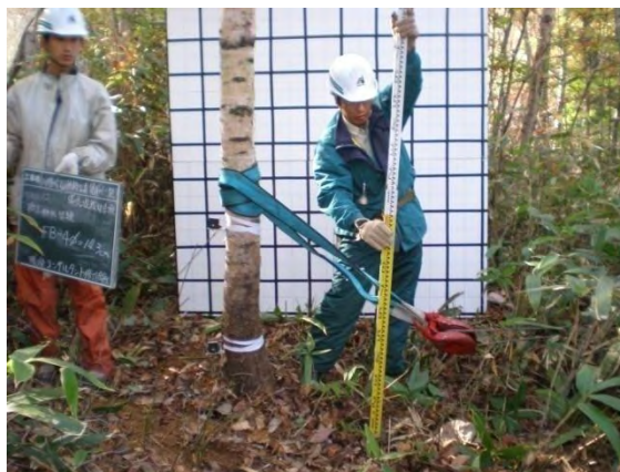
写真－2. シラカンバの引き倒し試験。
