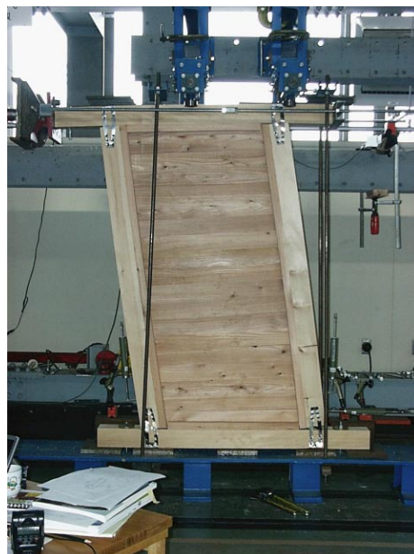
写真1 せん断試験の様子
