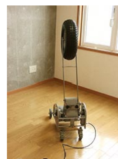
住宅の床衝撃音測定
