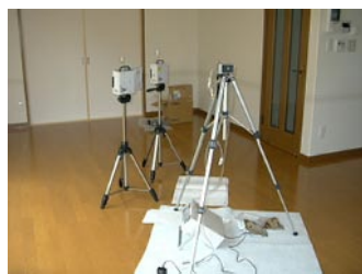
新築住宅内の化学物質測定
