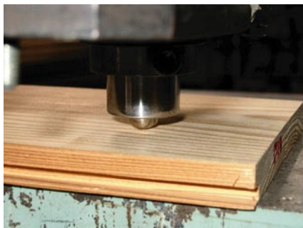
写真2 圧密化材の表面硬さ試験
