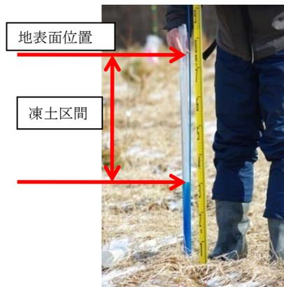
写真-1. 寡雪区における土壌凍結深度棒を地面から抜き出したところ
