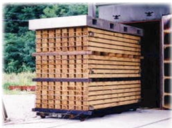
木材利用に関する技術開発 トドマツ平角材の高温乾燥試験 (旭川市・林産試験場)
