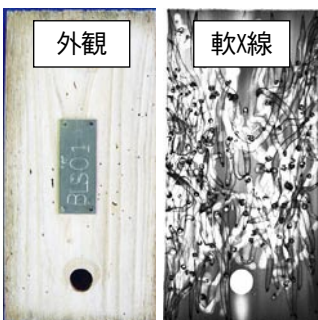
写真2 海虫による被害
