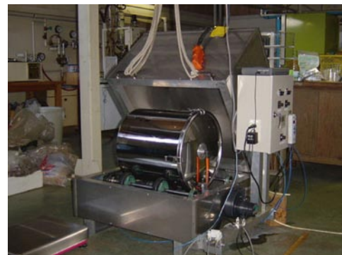
写真1 移動型堆肥化装置の試作機
