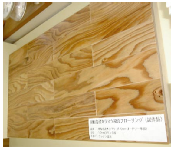
写真1 WPCカラマツによるフローリング材の試作
