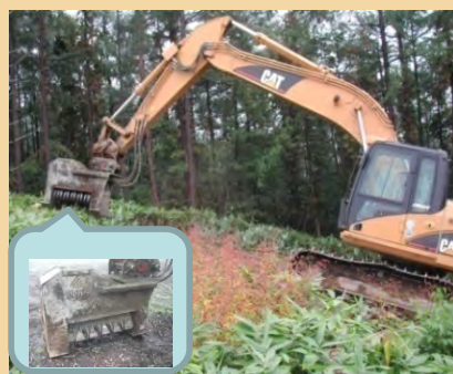
写真-1 ブラッシュカッター ・高速で回転する11枚の刃によって、ササなどの植生を刈払い、粉碎する。
