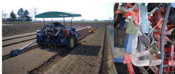
写真-1 北海道で普及率の高い床替え機(サンテクノ社製)(左)と改良した供給台(苗木をセットする台)とブレード(苗木をつかみ植えるハサミ)
