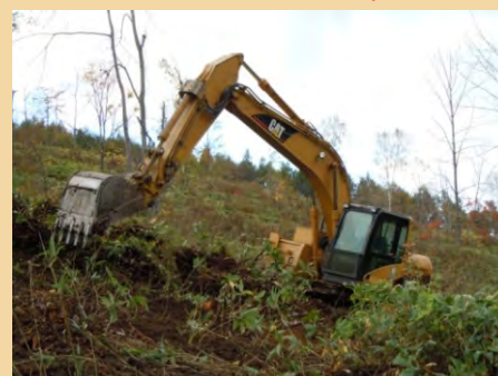
写真-3 油圧ショベル（バケット） ・標準装備のバケットにより、ササなど植生を根こそぎ剥ぎ取る「全剥ぎ地拵え」を行う
