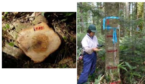
図-2 伐倒により腐朽状況を観察した個体の伐根（左）と樹内腐朽診断装置による調査風景（右）
