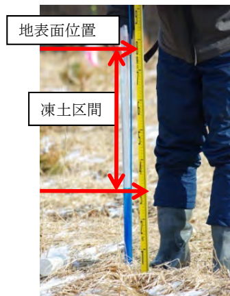
写真-1 寡雪区における土壌凍結深度棒を地面から抜き出したところ
