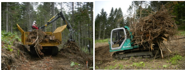
写真-1 バイオマスフォワーダ (MST-800VDL) *荷台に圧縮機能有り
