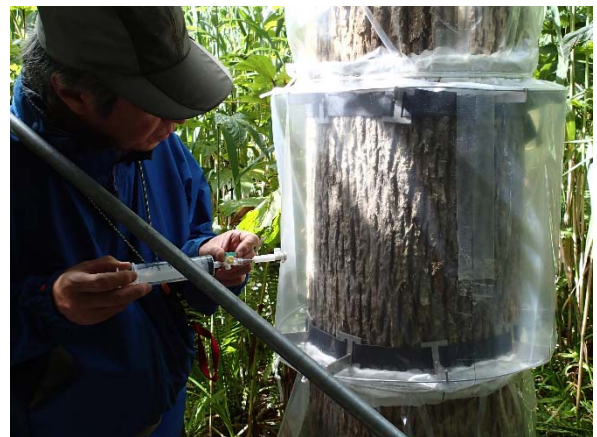
写真-1 円筒型チャンバによる樹幹フラックス観測
