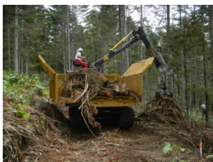
写真-1 バイオマスフォワーダ(MST-800VDL) *荷台に圧縮機能有り
