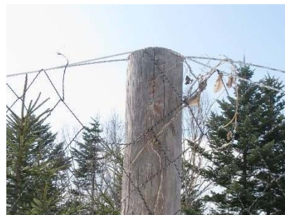
写真3 ワイヤロープが弛んだことで切断した網糸
