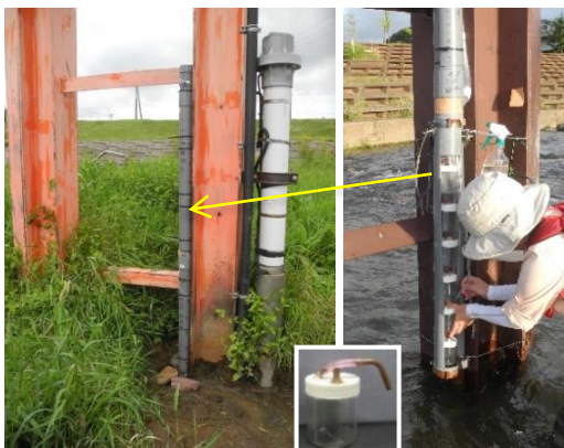
写真-1 ライジングステージサンプラーの設置状況
